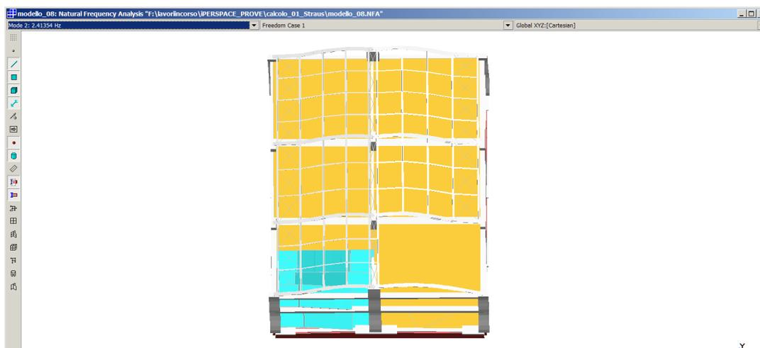
Segue un terzo modo, anch'esso globale, tipicamente torsionale, con  $T=0.28s$ :
