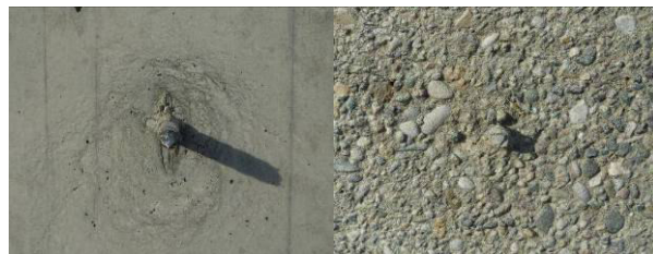
Figura 2. Campione RCJ1 prima e dopo la sabbiatura
