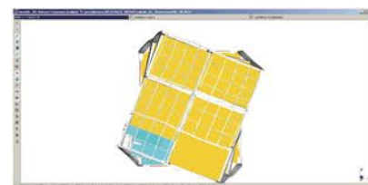
Deformata torsionale con Straus7
